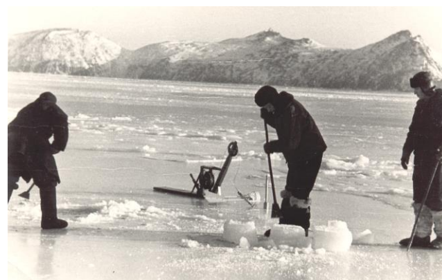
Исследование прочностных и структурных характеристик морского льда, измерение течений подолдом в проливе Босфор-Восточный. 1963 г.
